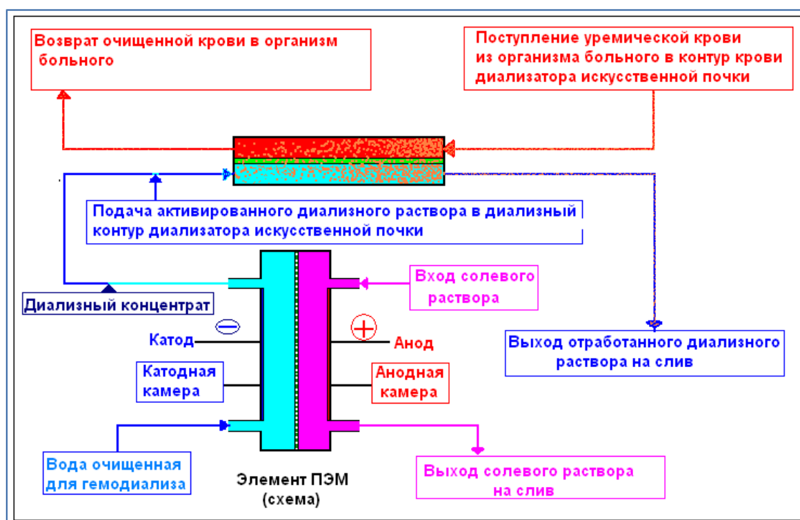
Рис. 3.4. Принципиальная схема электрохимического аппарата «Базекс», подключенного к диализатору искусственной почки.
